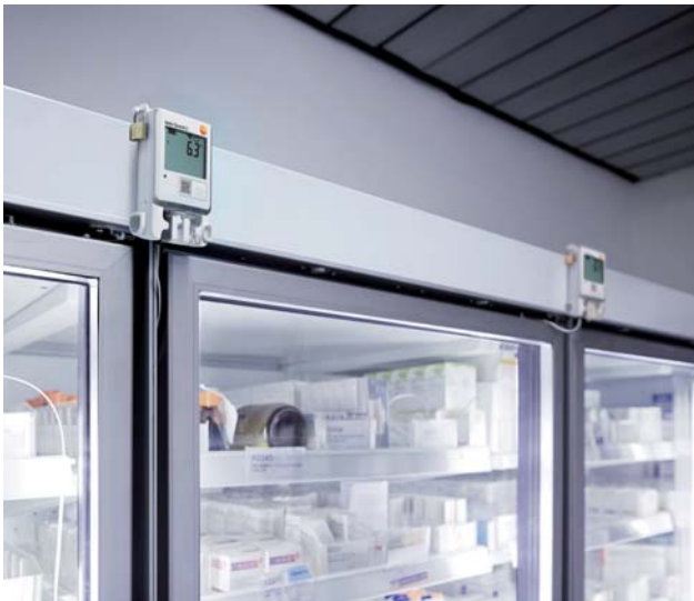
Con i data logger WiFi, documentate le temperature in tutti i frigoriferi senza sforzo manuale.
